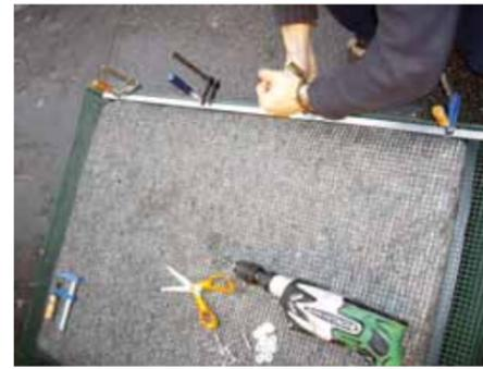
On fixe le premier profil de 1m20 sur un bord latéral avec les 4 serre-joints également répartis. Il faut disposer le bord du profil exactement à l'aplomb du rebord de la table de façon à ce qu'il y ait suffisamment d'espace pour la rondelle qui maintiendra le rivet pop. Pour cette étape, on laissera juste dépasser du profil le bord du grillage.
